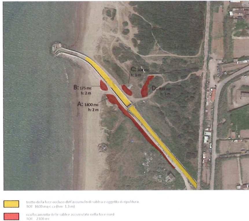
Fig. 10- Inquadramento su ortofoto: in giallo le superfici della foce da ripulire; in rosso le dune che si vengono a ripristinare con il ricollocamento delle sabbie.
