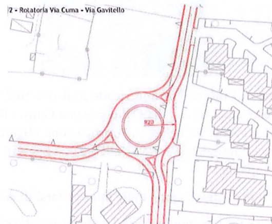
Piano Urbanistico Comunale adottato - Nodo viabilità B5 Figura 23. Intervento V3: Rotatoria di progetto tra via Cuma e via Gavitello
