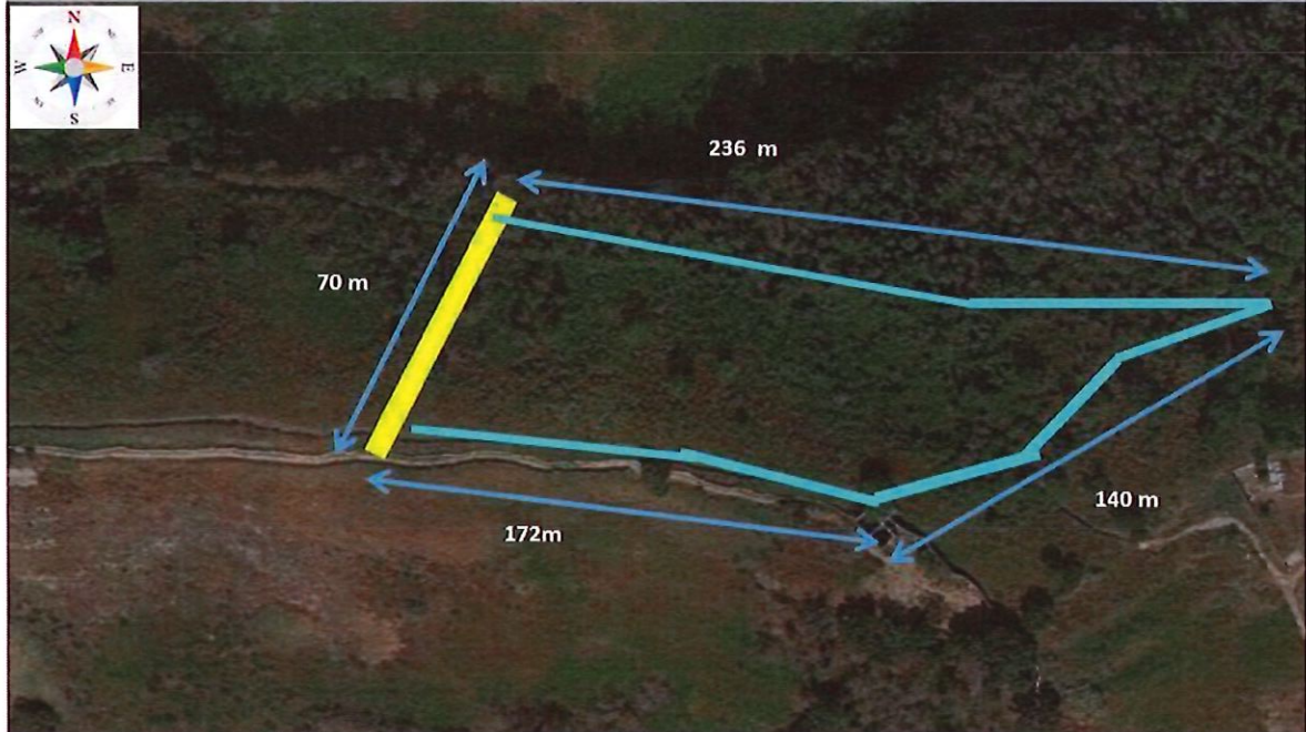
Figura 6 - Fasce di contenimento previste nel Cantiere 1
