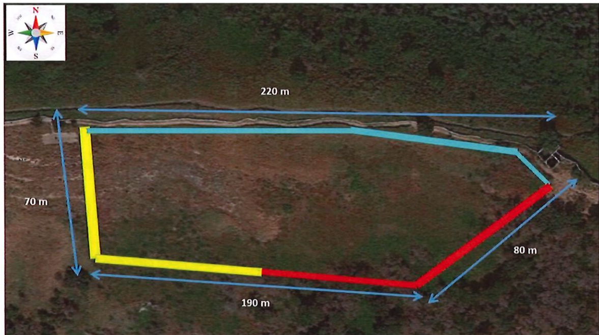
Figura 7 - Fasce di contenimento previste nel Cantiere 2
